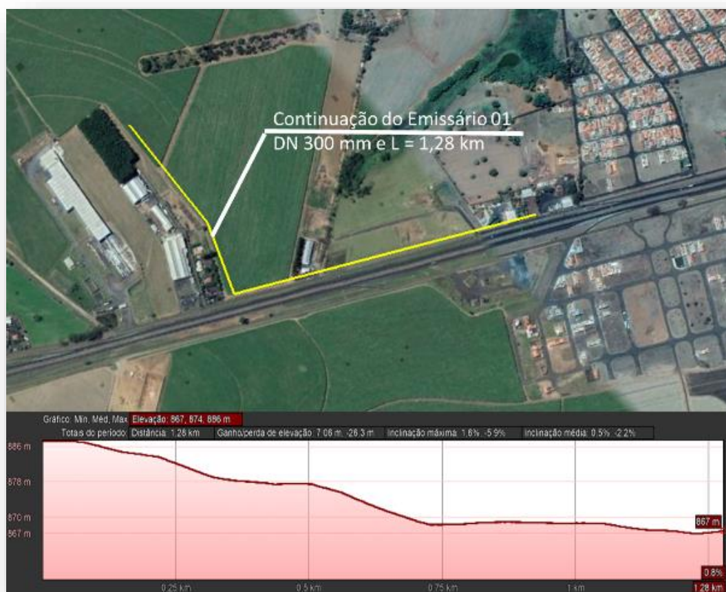
Figura 236 – Planta e Perfil do Prolongamento do Emissário 01
