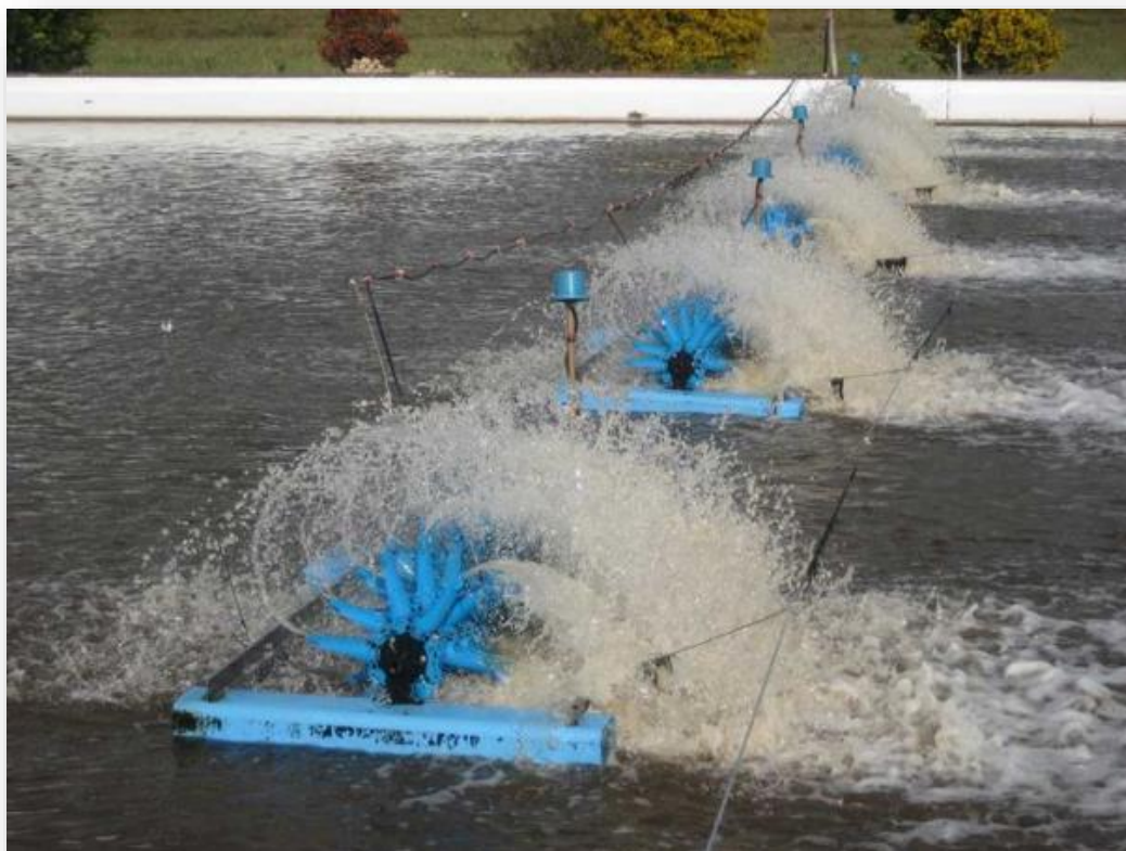
Figura 239 – Aerador Mecânico Flutuante
