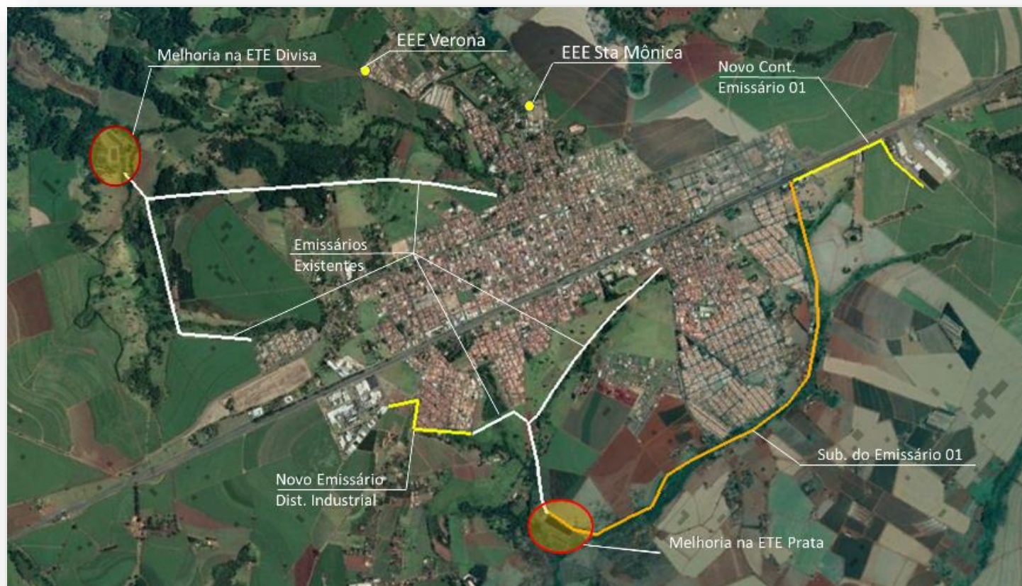
Figura 238 – Sistema de Esgotamento Sanitário Proposto – Curto Prazo
