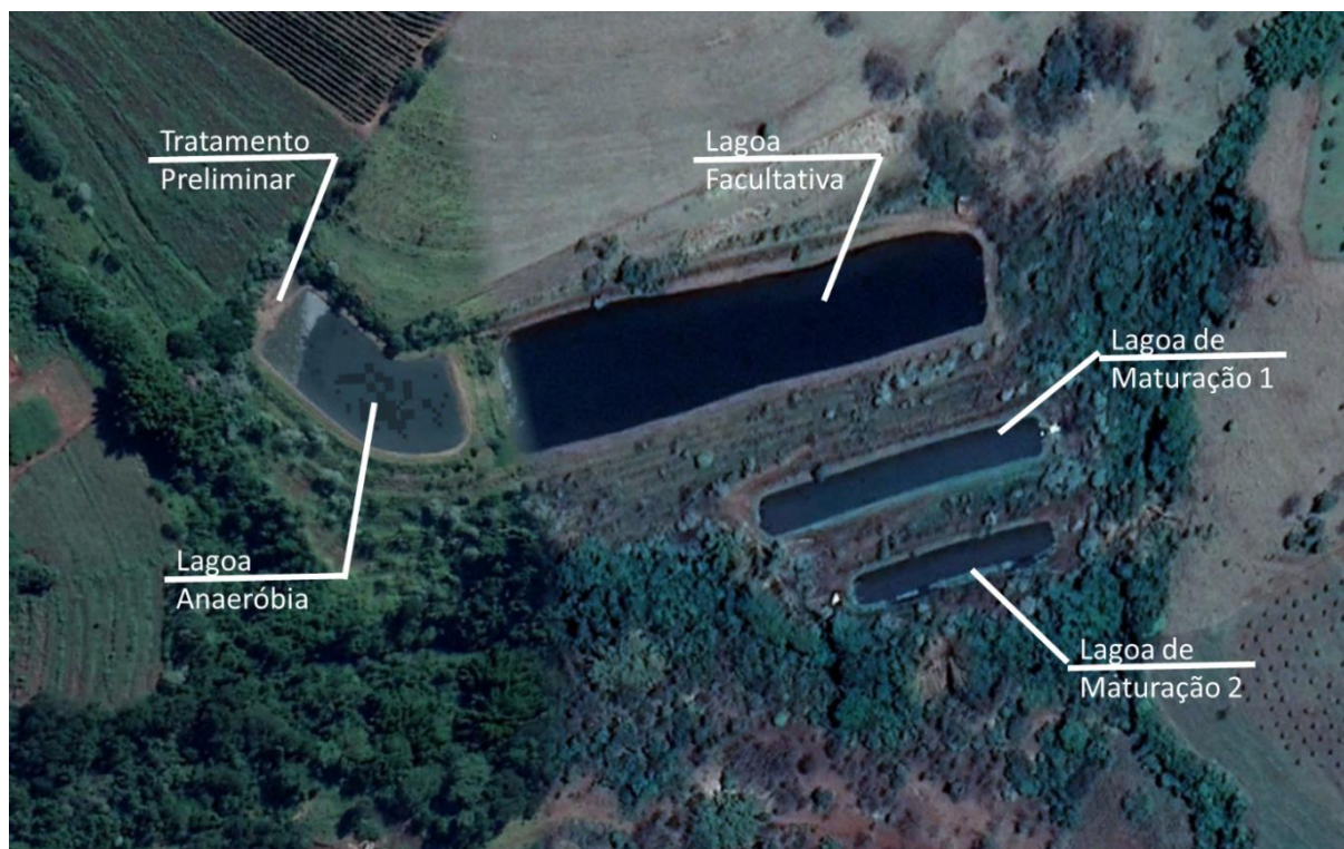
Figura 5.4: Localização e identificação das unidades de tratamento da ETE Prata
