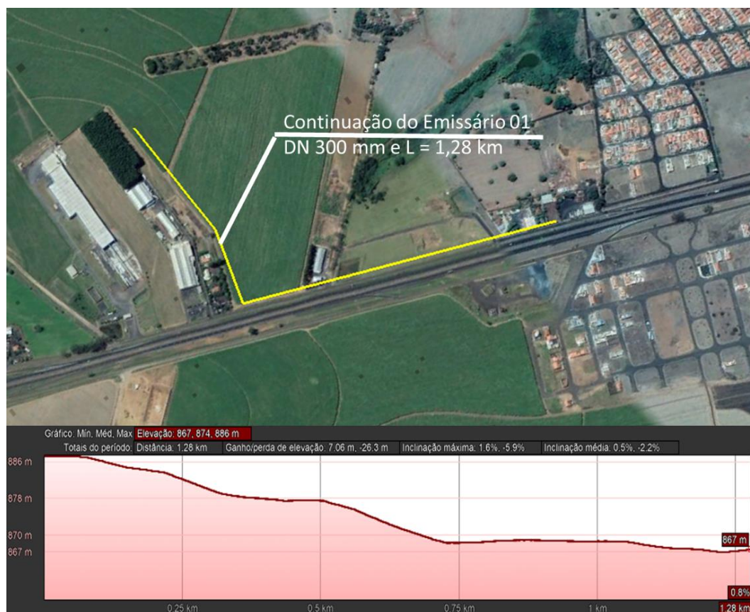
Figura 5.11: Planta e perfil do prolongamento do emissário 01
