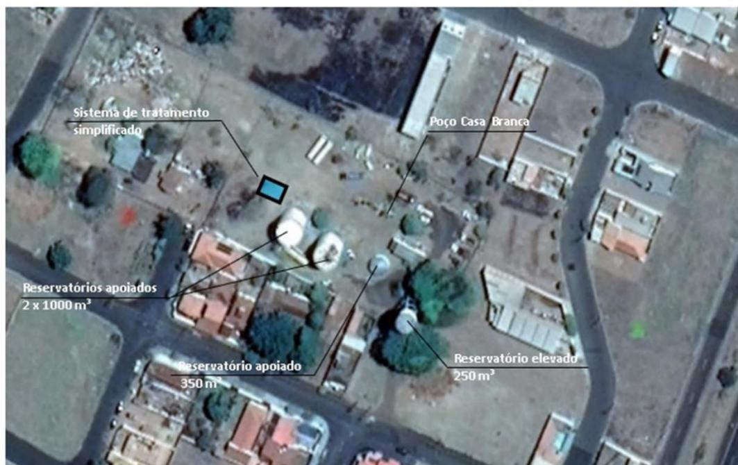
Figura 4.8: Local de implantação do sistema de tratamento simplificado no CPR Casa Branca
