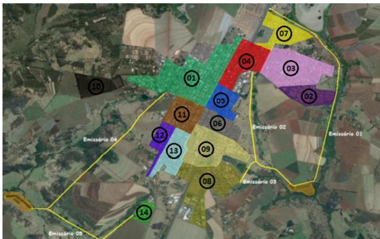
**Figura 5.2: Localização das sub-bacias de esgotamento sanitário.**
