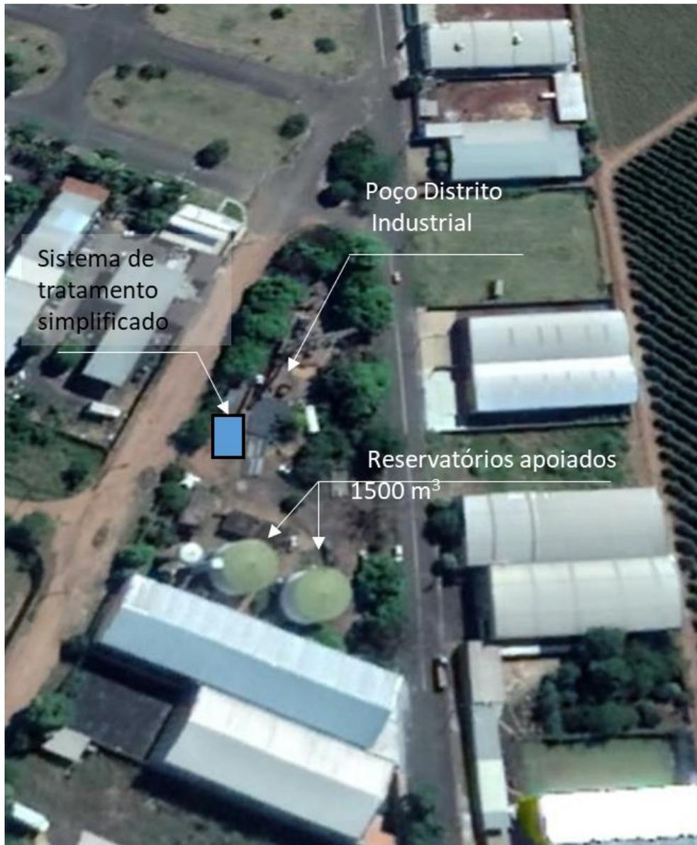
**Figura 4.9:** Local de implantação do sistema de tratamento simplificado no CPR Distrito Industrial
